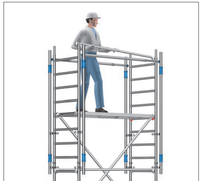
Bild 6: Sichere Montage der Rückenlehnen mit MSG
