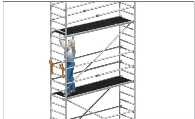
4. Beide Diagonalen **22** und die Durchstiegsbrücke **27** einsetzen.
