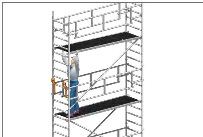
4. Die zweite Diagonale **22** und die Durchstiegsbrücke **27** einsetzen.
