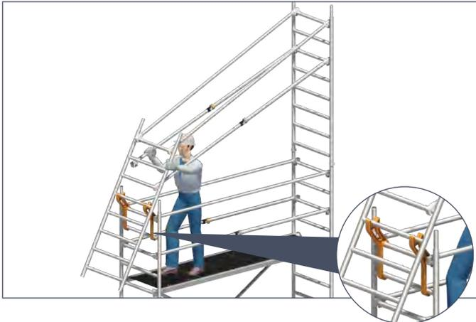
2. Anbringen der Uni Montagehaken **29** und Positionierung der zweiten Standleiter 75/8 **15**. Zwei Geländer **17** an der jeweils obersten Sprosse der aufgesteckten Standleiter 75/8 **15** einhängen und mit einer zweiten Standleiter 75/8 **15** verbinden. Zwei Uni Telegeländer **20** jeweils zwei Sprossen unter den Geländern **17** einhängen und diese in der entsprechenden Sprosse ebenfalls mit der zweiten Standleiter 75/8 **15** verbinden.
