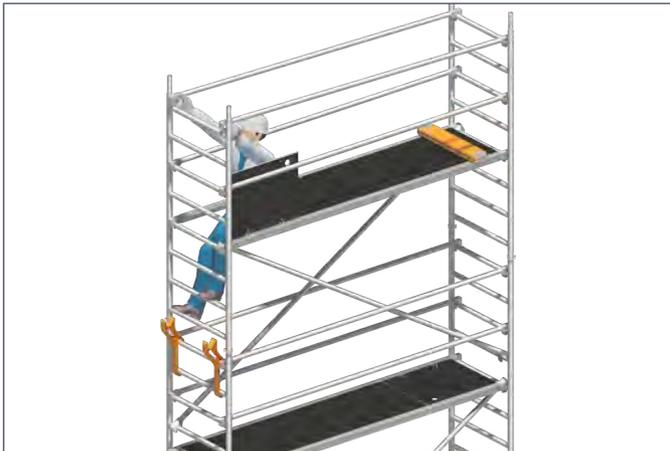
3. Nach dem Abstieg auf die darunterliegende Plattform werden die Durchstiegsbrücke **27** und die Diagonalen **22** demontiert.
