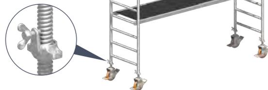
1. Die Lenkrollen **1** werden in die Standleitern 75/8 **15** eingesteckt und durch Festdrehen der Flügelschrauben an den Spindelmuttern gegen Herausfallen gesichert.
