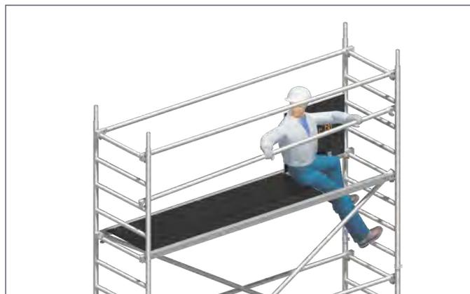
5. Innenseitiger Aufstieg über die Sprossen der Standleiter durch die dafür vorgesehene Durchstiegsklappe. In der Durchstiegsöffnung sitzend, absturzesichert durch die Holme der Durchstiegsbrücke **27**, erfolgt die Montage des Zwischengländers der nächsten Lage. Hierzu werden die Geländer **17** an den zweiten Sprossen über der Standfläche montiert.
