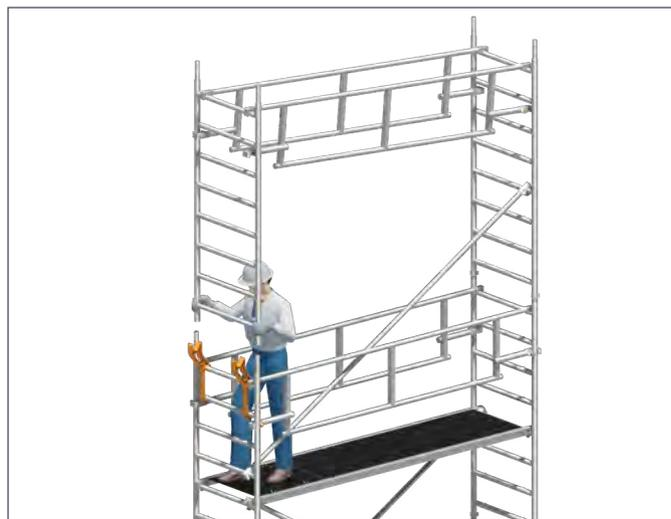
5. Die Standleiter **75/8 15** auf der Seite der Uni Montagehaken ausheben und mitsamt der beiden Sicherheits-Doppelgeländer **17** nach unten schwenken und in den Montagehaken **27** positionieren.
