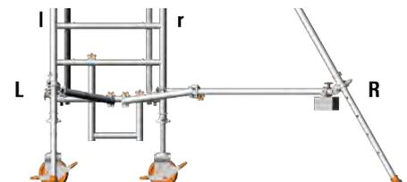
Bei seitlicher Aufbauvariante mit Wandabstützung ist die Abstützung immer auf der Seite „L“ anzubringen.
