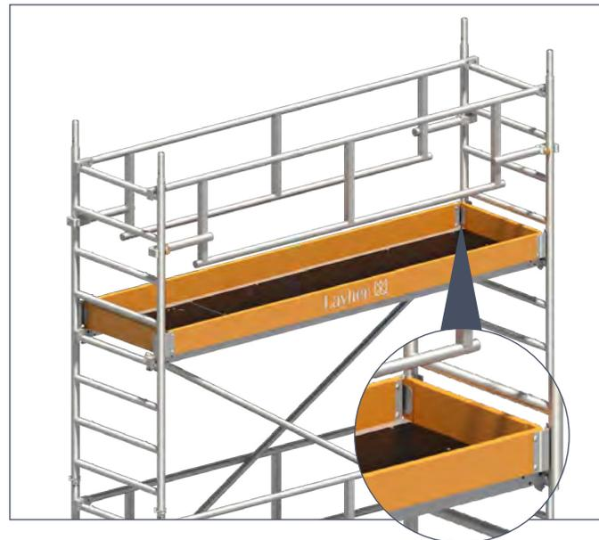
Zum Abschluss der Arbeitsbühne müssen Bordbretter mit Klaue **32** und Stirnbordbretter **33** angebracht werden.
