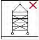
Fahrbare Arbeitsbühnen sind im Standard nicht dafür konstruiert, angehoben oder angehängt zu werden.
