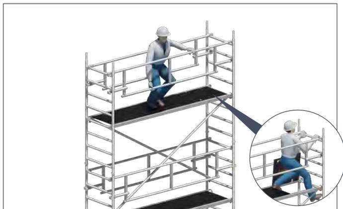
5. Aufsteigen und Betreten der nächsthöheren Plattform, die bereits vollständig mit zweiteiligem Seitenschutz gesicherten ist. Fixieren der Sicherheits-Doppelgeländer **19** durch leichten Druck nach außen um die unteren Klauen im Holmrohr der Standleiter einzurasten.
