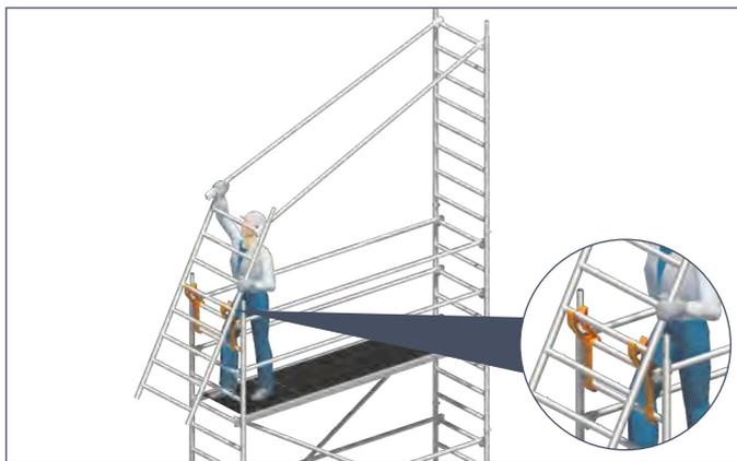
2. Anbringen der Uni Montagehaken **29** und Positionierung der zweiten Standleiter 75/8 **15** zur Montage der Geländer **17**.
