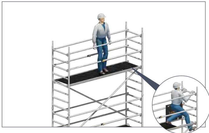
5. Betreten der nächsthöheren Plattform, die bereits vollständig mit zweiteiligem Seitenschutz gesicherten ist.
