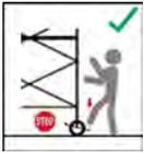
Nach dem Verfahren sind die Lenkrollen durch Niederdrücken des Bremshebels zu arretieren.
