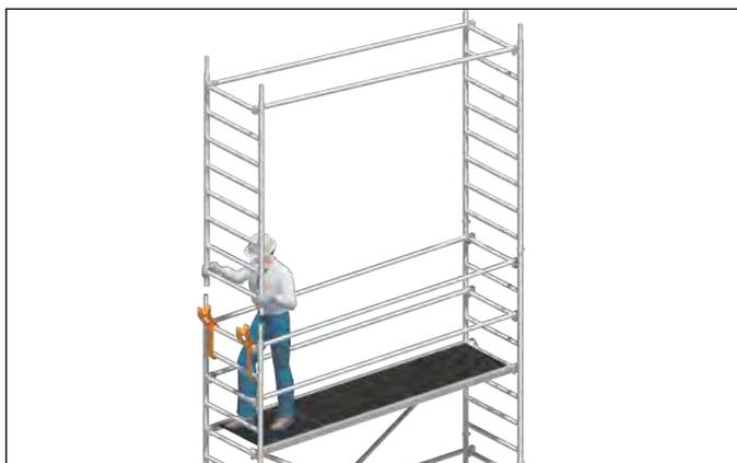
3. Standleiter 75/8 **15** mit Geländern **17** nach oben schwenken, aufstecken und mit Federsteckern **16** sichern.
