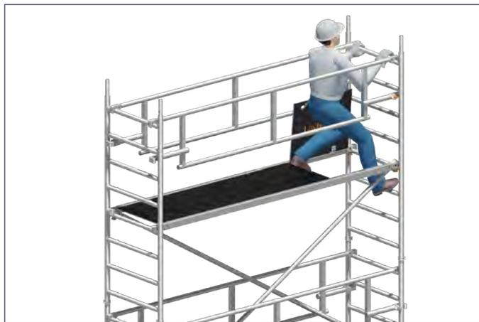
3. Nach dem Abstieg auf die darunterliegende Plattform werden die Uni Montagehaken **29** angebracht und es kann das Entfernen der darüberliegenden Federstecker **16** erfolgen.
