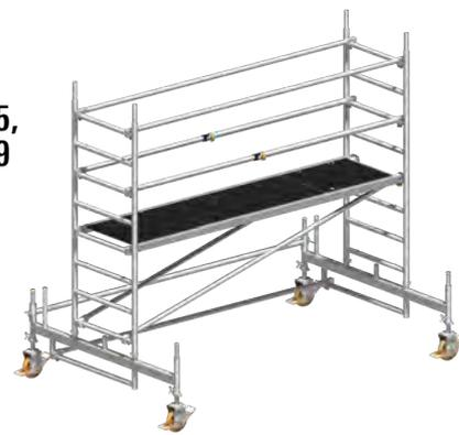
1. Die Lenkrollen **1** in die Fahrbalken **6/7** einstecken und durch Festdrehen der Flügelschrauben an den Spindelmuttern gegen Herausfallen sichern.
