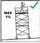
Fahrbare Arbeitsbühnen sind durch die Ausgleichsspindel oder durch Unterlegen von geeigneten Materialien lotrecht zu stellen. Die max. Neigung darf 1% (in horizontaler Ausrichtung = Gerüstlänge / 100) betragen.
