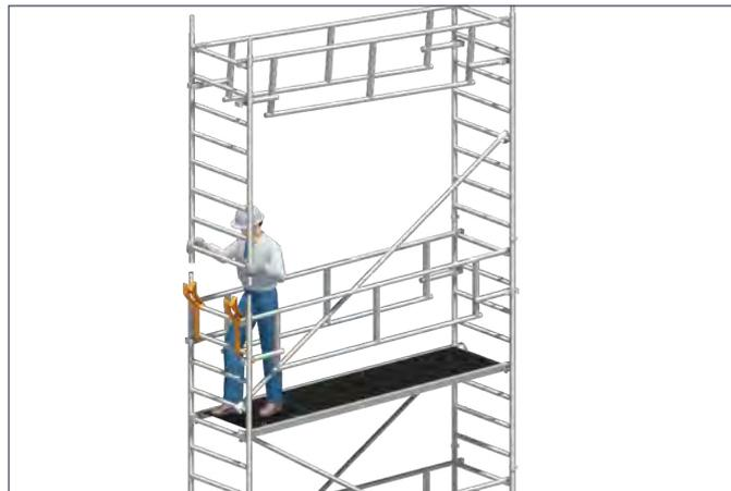
3. Die Standleiter 75/8 **15** aus der Position in den Uni Montagehaken **29** nach oben schwenken, aufstecken und mit Federsteckern **16** sichern.
