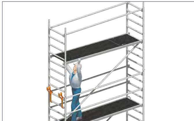
4. Diagonalen **22** und Durchstiegsbrücke **27** einsetzen. Die Diagonalen müssen auf beiden Seiten turmartig (zickzackförmig) eingebaut werden.
