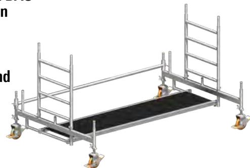
1. Die Lenkrollen **1** in die Fahrbalken **6/7** einstecken und durch Festdrehen der Flügelschrauben an den Spindelmuttern gegen Herausfallen sichern.
