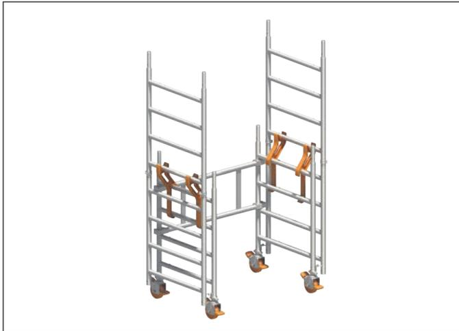
2. Montage der 4 teleskopierbaren Geländer, jeweils außen an der obersten Sprosse, sowie der 3. Sprosse von oben der positionierten Standleitereinheiten.
