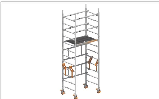
5. Montage der Gerüststützen **5** an allen 4 Holmen der bereits gesteckten Standleitern (s. S. 15, Kapitel 7. Gerüststützen-Anbau).
