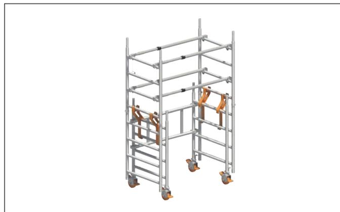
3. Aufstecken der Standleitereinheiten durch nach oben schwenken der Standleitereinheiten mit den vormontierten telekopierbaren Geländern in die dafür vorgesehenen Rohverbinder der Standleitern 1 m **1** im Grundaufbau. Die Stöße im Anschluss mit Federsteckern **9** sichern.
