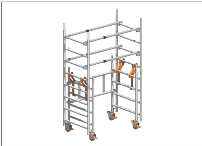
3. Aufstecken der Standleitereinheiten in die dafür vorgesehenen Rohrverbinder durch nach oben schwenken mit den bereits montierten teleskopierbaren Geländern.
