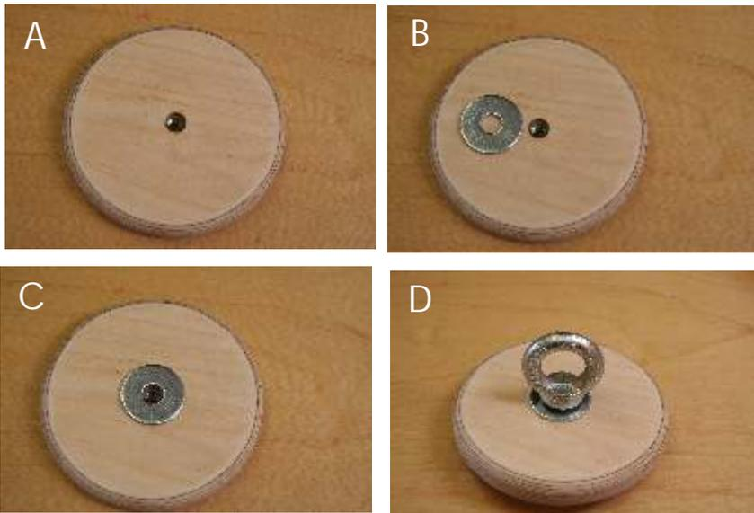
Das ist wichtig, sonst kann die Ösen-Schraube mit Gewinde aus dem Holz-Teller gerissen werden und im Notfall kann keine Reparatur erfolgen.
