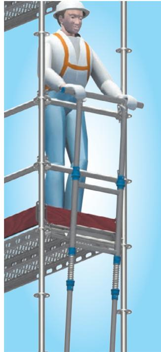
Stirn-Montage-Sicherungs-Geländer nach außen schwenken und nach oben versetzen.
