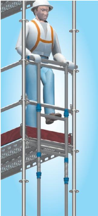
Auf gesicherter Lage stehend, die obere Quersprosse mit dem Fuß nach unten drücken, um das obere U-Profil vom Belagriegel zu lösen.
