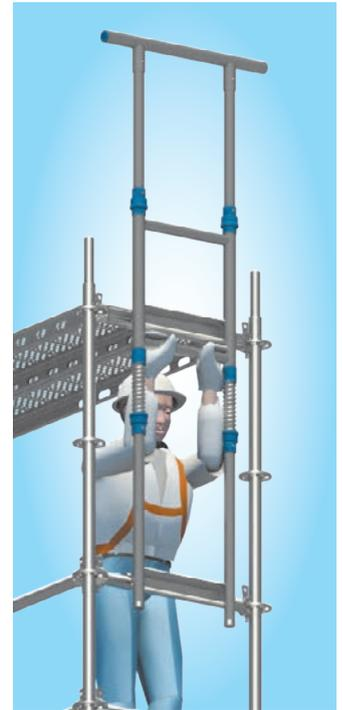
Die untere Quersprosse so weit nach unten ziehen, bis sich das obere U-Profil unter den Belagriegel schwenken lässt. Durch Loslassen der unteren Quersprosse wird das Stirn-Montage-Sicherungs-Geländer gesichert.
