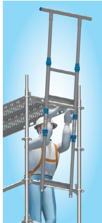
Stirn-Montage-Sicherungs-Geländer mit dem unteren U-Profil auf dem Geländerholm aufsetzen.
