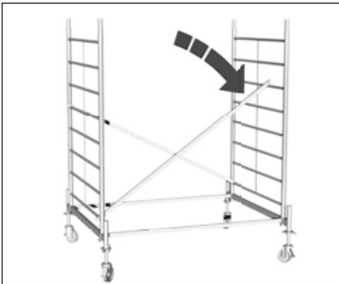
Nehmen Sie die zweite Diagonale und montieren Sie diese, wie im Bild gezeigt, entgegengesetzt diagonal von der ersten in die fünfte Sprosse und befestigen Sie auch diese mit den Sicherungssets.
