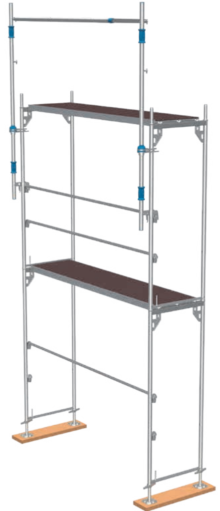
Bild 29: Umsetzen eines zweiten Montagepfostens in die nächst höhere Lage
