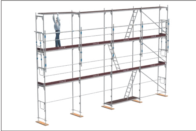
Bild 47: Abbau der jeweils obersten Gerüstlage
