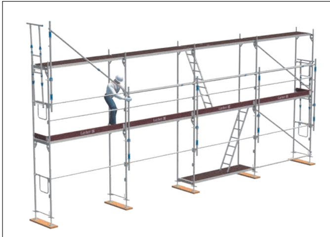
Bild 43: Ersten Montagepfosten nach oben umsetzen
