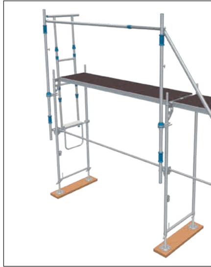
Bild 34: Zweiter Montageposten montiert
