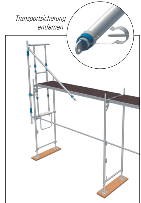
Bild 32: Montage der vormontierten MSG-Einheit am Stellrahmen
