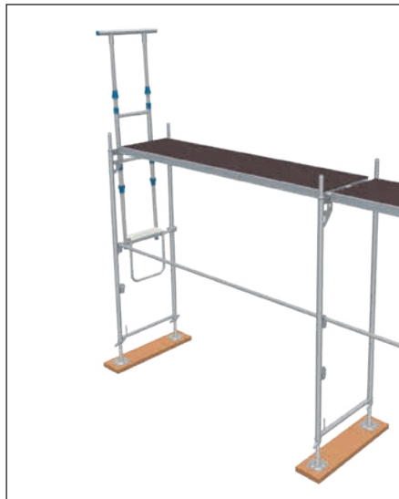
Bild 30: Montage des Stirn-MSGs am Stellrahmen
