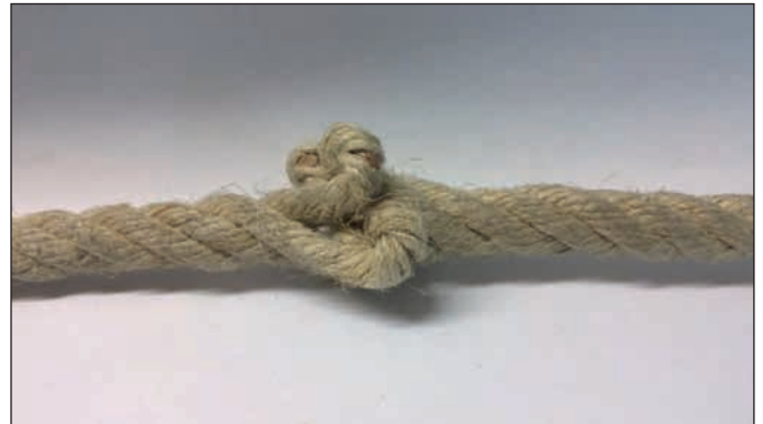
Ausgezogene Kinke (Seil ablegen) – Verschleißgrenze erreicht!
