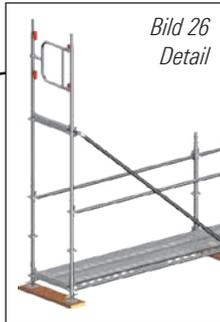
2. Der Weiterbau erfolgt gemäß der Schritte 8–20, Innen- und Außenseite mit dem AGS-Stiel LW 2,0 m. Gegebenfalls kann auf der Innenseite auf das Bordbrett verzichtet werden.
