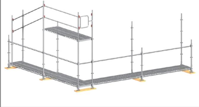
7. Böden einhängen und mit Abhubsicherungen sichern.
