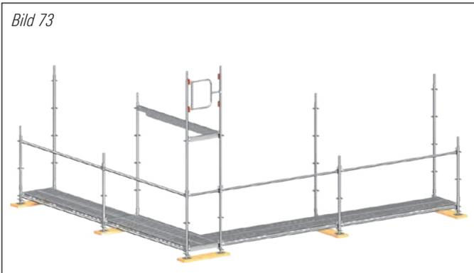
3. AGS-Stiel mit vormontiertem AGS-Doppelstirngeländer aufstecken. Zweiten AGS-Stiel aufstecken und beide mit einem Querriegel verbinden.
