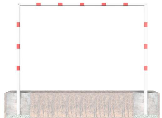
5. Querholm und Stanpfosten mit der Wasserwaage ausrichten
