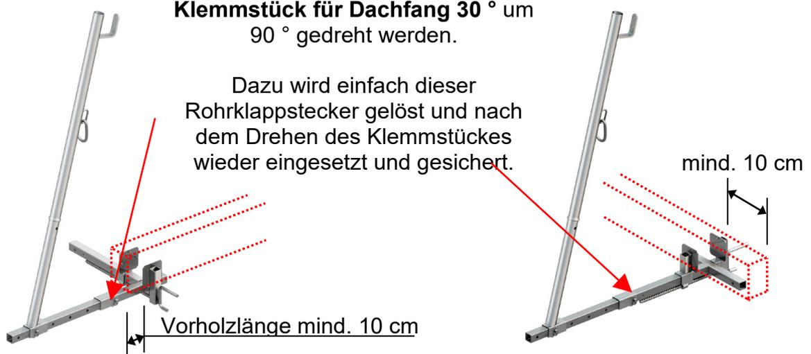
Die Klemmstücke der Dachfänge 30 ° dürfen nur an durchgehenden, senkrecht zur Traufe liegenden Sparren bzw. parallel zur Traufe liegenden Pfetten aus Vollholz (Mindestquerschnitt **8 x 12 cm**) befestigt werden. Die Hölzer dürfen nicht beschädigt sein und müssen gesundes Holz aufweisen. Befestigungen an Aufschieblingen, Auswechslungen und dgl. sind unzulässig.
