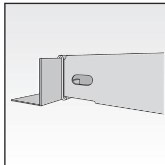
Stahlfachböden in Trägerlaschen (Grundfeld) und Fachbodenträger (Rahmen Anbaufeld) einlegen.
