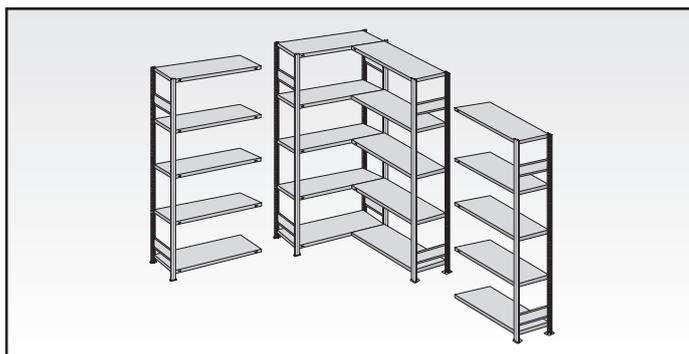
Montage weiterer Anbaufelder auf beiden Seiten möglich. Die Aussteifung der weiteren Anbaufelder erfolgt über Kreuzdiagonalen.
