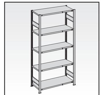
Je nach gewünschter Anzahl der Fachebenen zwei Längenriegel pro Ebene in die vormontierten Rahmen einhängen und mit Sicherungsstift arretieren. Stahlfachböden einlegen und je Fachebene zwei Trägerlaschen zur Aufnahme der Stahlfachböden des Anbaufeldes einhängen.
