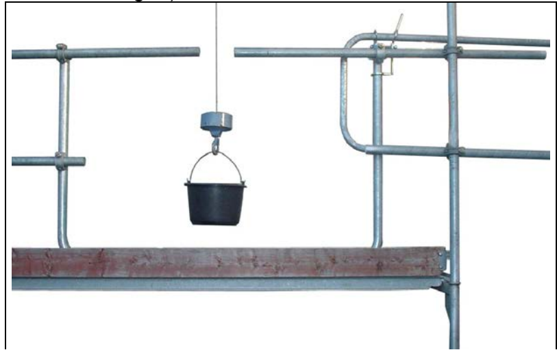
Fig. 6 Sicherung der Be- und Entladestelle
