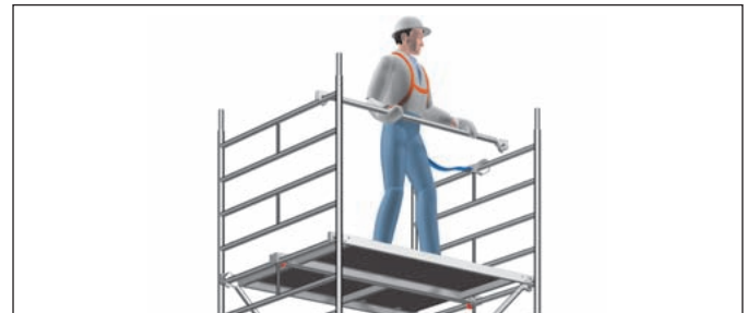
Bild 3: Sichere Montage der Rückenlehnen mit PSA
