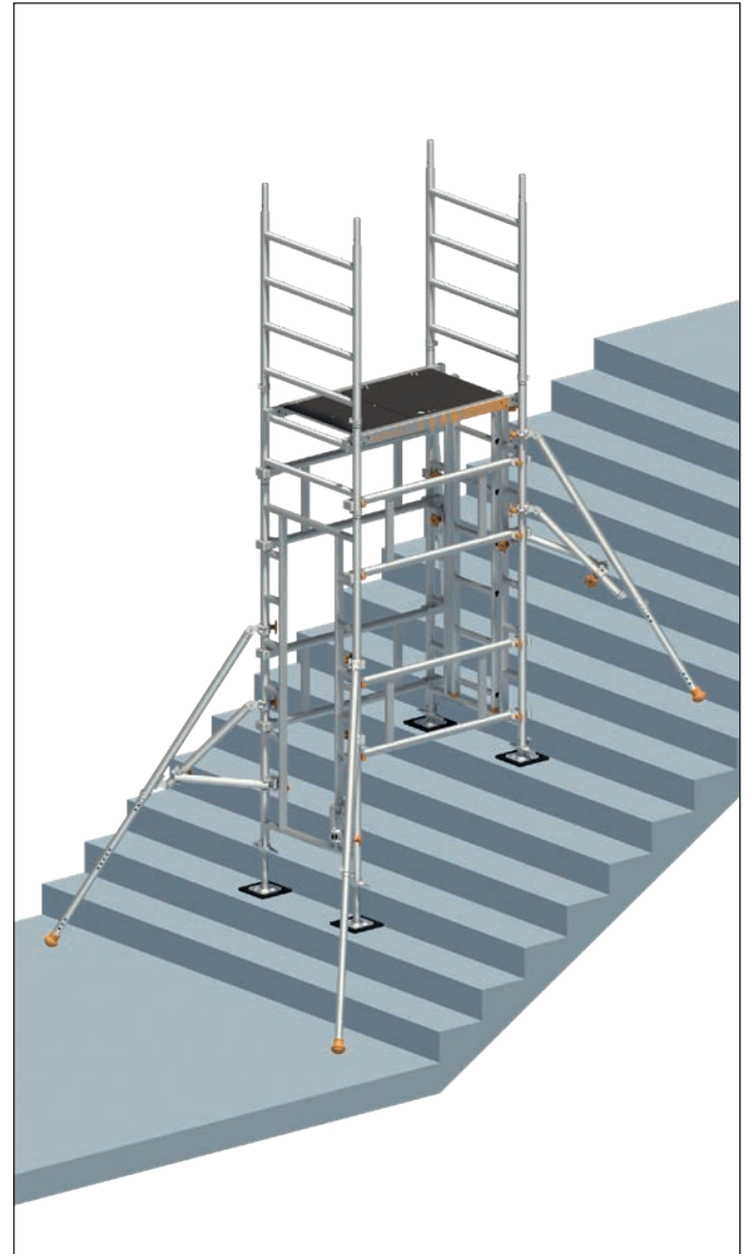
10. Montage der Eihängeleiter 8 (s. S. 21, Kapitel 8. Eihängeleiter-Anbau) für einen sicheren Aufstieg.
