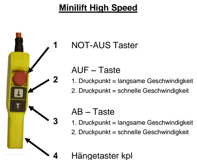
Abb. 16: Bedienung Minilift High Speed
