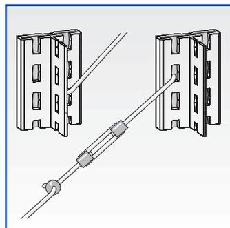
Die Kreuzstreben mit den Spannschlössern zusammen in die hinteren Profile der Rahmenstütze einhängen. Unten beginnend, in der ersten frei zugänglichen Lochung über der Fußplatte.
