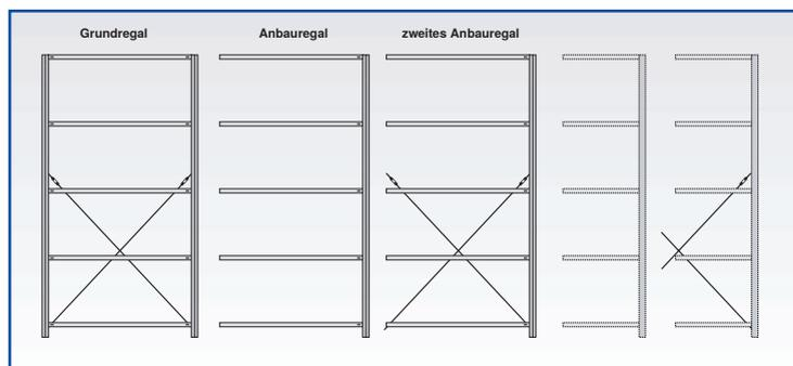
An das stehende Grundregal werden an einer Seite die Anbauregale angefügt. Zur Aussteifung der Anbaufelder erfolgt die Montage mit Kreuzstreben in jedem zweiten Anbaufeld, gemäß Abbildung.
