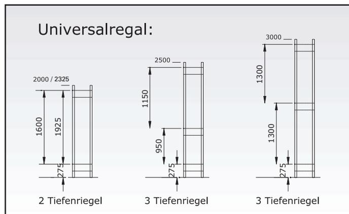
Die exakte Anordnung der Tiefenriegel bitte gemäß diesen Abbildungen abhängig von der Feldlast und der Regalhöhe durchführen.
