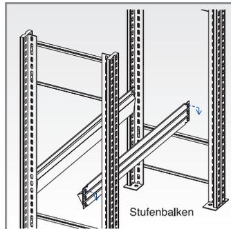
Stufenbalken beidseitig auf gewünschte Fachebene einhängen, mit Gummihammer festklopfen und als Aushebesicherung mit den Sicherungsstiften sichern. Dabei in der obersten und untersten Ebene beginnen. In der Anwendung als Felgen-/Reifenregal sind die Stufenbalken als Aushebesicherung mit Blechschrauben 6,3 x 25C zu befestigen.
