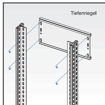
Rahmenstützen paarweise anordnen, Tiefenriegel einhängen und mit der Rahmenstütze verschrauben (M6x12-8.8) oder mit Niete 6,0x8 vernieten. Verbundene Stützenpaare aufrichten und für die Dauer der Montage sichern.
