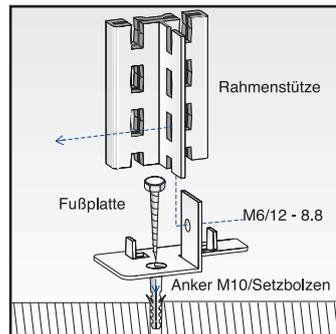
Fußplatte (Stahlfuß) in Rahmenstütze liegend einsetzen und verschrauben (M6x12-8.8) oder mit Niete 6,4x12 vernieten. Bei vormontierten Rahmen vernietet mit Stahlnieten.
