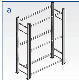
Die Aussteifung mit Längenriegeln sichert Ihnen den optimalen Zugang von beiden Regalseiten (beidseitige Bestückung). Längenriegel je nach Regalhöhe in der notwendigen Anzahl (Abb. c) und im vorgeschriebenen Rasterabstand in die Rahmen einhängen (Abb. a), mit Sicherungsstift arretieren (Abb. b) und je einen Fachboden einlegen (ohne Fachbodenträger).
