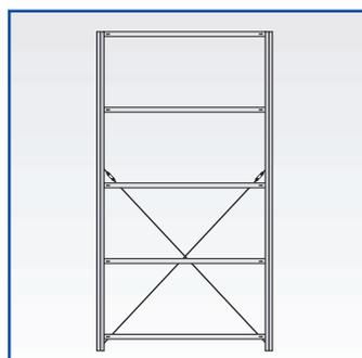
Dann die übrigen Fachbodenträger je nach gewünschter Fachebenhöhe in der Rasterlochung einhängen und die Stahlfachböden einlegen.
