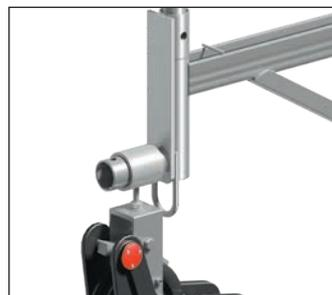
Das Rohrdrehgelenk des Aufzugsrades mit Fallbremse über den horizontalen Rohrstummel des Konsoladapters stecken.
