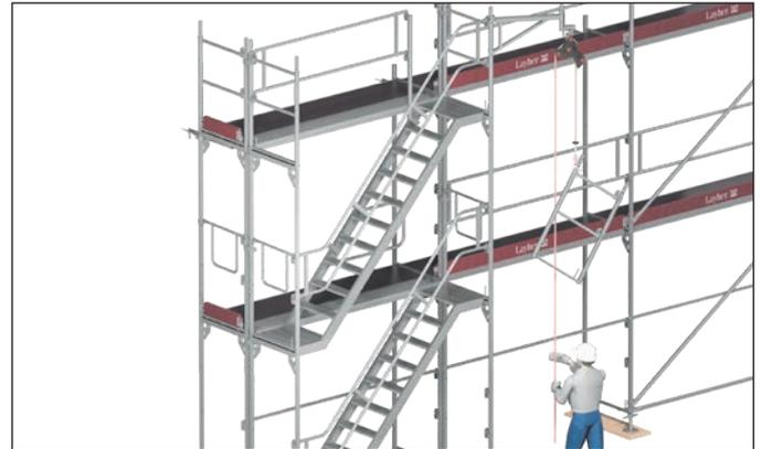
Zum Lösen der Keilbremse das Seil kurz senkrecht nach unten ziehen, wenn das Seil frei ist, ziehen die zusätzlich angehängten 5 kg Gewicht das Lastseilende nach unten und das Seil gleitet lose durch die Hände. **Vorsicht: Achten Sie auf das Lastseilende.**
