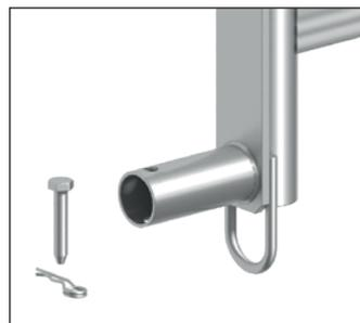
Den am Konsoladapter vormontierten Bolzen mit Sicherungsstecker demontieren.
