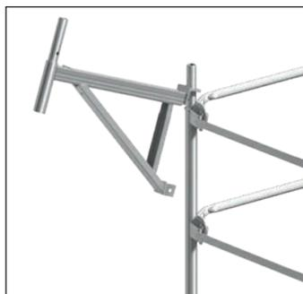
Eine Konsole 0,73m schwenkbar über einen Rohrverbinder der obersten Lage stecken. Alternativ kann eine Konsole mit Halbkupplung am Knotenblech des Stellrahmens angebracht werden.
