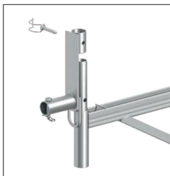
Den Konsoladapter für das Aufzugsrad über den Rohrverbinder der Konsole stecken.
