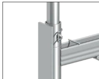
Den Konsoladapter mit einem Rohrklappstecker am Rohrverbinder sichern. Alternativ kann ein Fallstecker, ein Bolzen mit Sicherungsstecker oder eine Schraube M12 mit Mutter verwendet werden.
