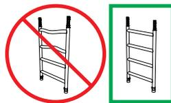
Es dürfen nur unbeschädigte und fehlerfreie Originalteile des Gerüstsystems des Herstellers, auf das sich die Prüfbescheinigung bezieht, verwendet werden. Vor der Benutzung der Gerüste sämtliche Teile auf richtigen Zusammenbau und ihre Funktionsfähigkeit überprüfen.
