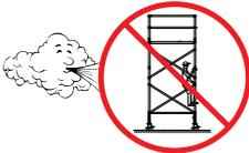
Bei der Verwendung im Freien oder in offenen Gebäuden das Gerüst bei Windstärke über 6 (nach Beaufortskala), bei aufkommendem Sturm und bei Arbeitsende in einen windgeschützten Bereich verfahren oder durch andere geeignete Maßnahmen (z. B. Verankern) gegen Umkippen sichern. Das Überschreiten der Windstärke 6 (12m/s) ist an einer spürbaren Hemmung beim Gehen erkennbar.
