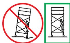
Das Aufbauen des Gerüsts ist nur lotrecht auf horizontal ebennem, ausreichend tragfähigem Untergrund zulässig. Gegebenenfalls lastverteilende Unterlagen verwenden.
