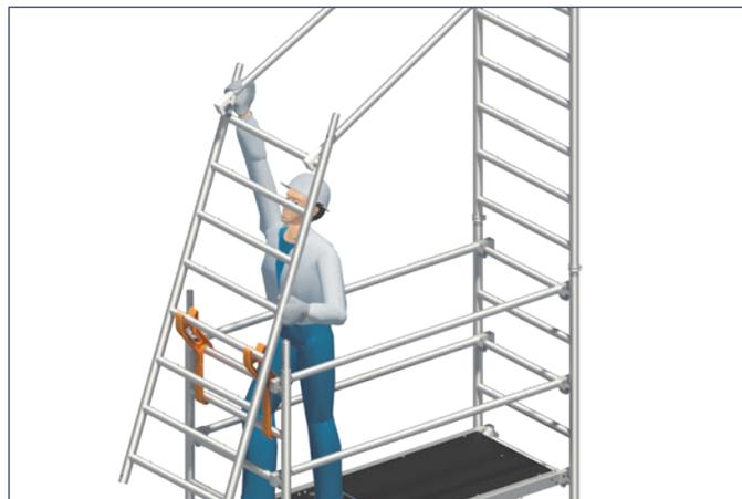
6. Einseitiges Aushängen der Geländer 20 aus der positionierten Standleiter.
