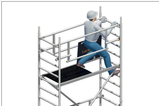
3. Nach dem Abstieg auf die darunterliegende Plattform werden die Uni Montagehaken **32** angebracht und es kann das Entfernen der darüberliegenden Federstecker **19** erfolgen.
