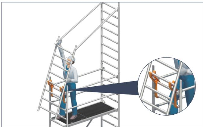
2. Anbringen der Uni Montagehaken **32** und Positionierung der zweiten Standleiter 75/8 **18** zur Montage der Geländer **20**.
