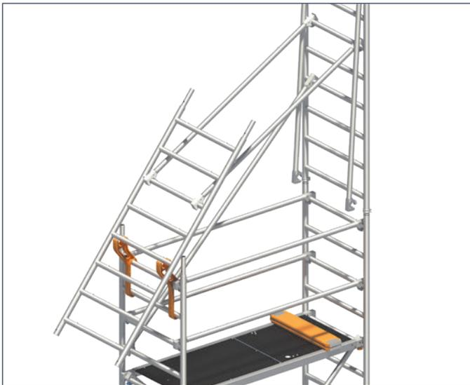
12. Durch ein außenseitiges Vorbeiführen der oberen, bereits einseitig gelösten Geländer **20** an den oberen Enden der in den Uni Montagehaken **32** positionierten Standleiter werden diese in der späteren Ausbaulage positioniert.
