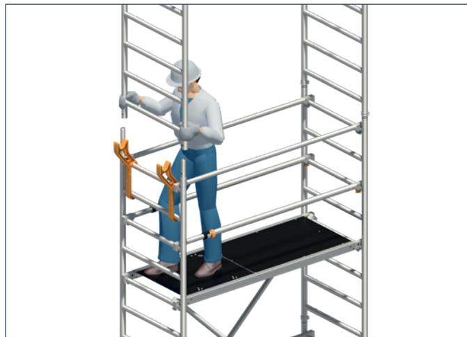
5. Standleiter 75/8 **18** auf der Seite der Uni Montagehaken ausheben, mitsamt des noch montierten Seitenschutzes nach unten schwenken und in den Montagehaken **27** positionieren.
