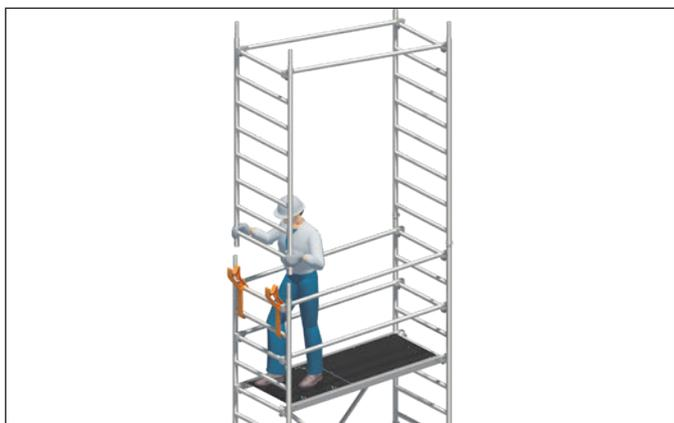
3. Standleiter 75/8 **18** mit Geländern **20** nach oben schwenken, aufstecken und mit Federsteckern **19** sichern.
