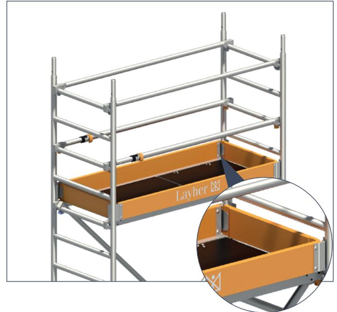
Zum Abschluss der Arbeitsbühne müssen Bordbretter mit Klaue **33** und Stirnbordbretter **34** angebracht werden.
