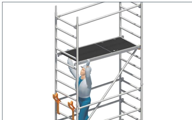
4. Diagonalen **25** und Durchstiegsbrücke **31** einsetzen. Die Diagonalen müssen auf beiden Seiten turmartig (zickzackförmig) eingebaut werden.
