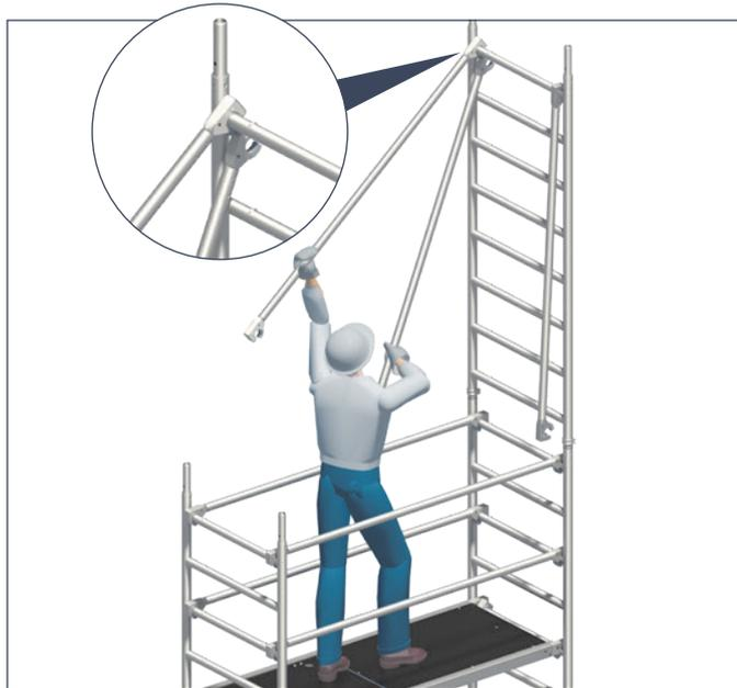
7. Demontage der Geländer 20 durch öffnen der Einrastklauwe mithilfe von einem der unter 2. demontierten Zwischengeländer. Das lose Geländer 20 wird auf die 2. Sprosse von oben aufgelegt und wirkt als Hebel zum Öffnen des Schließbügels der Einrastklauwe (siehe Detail).
