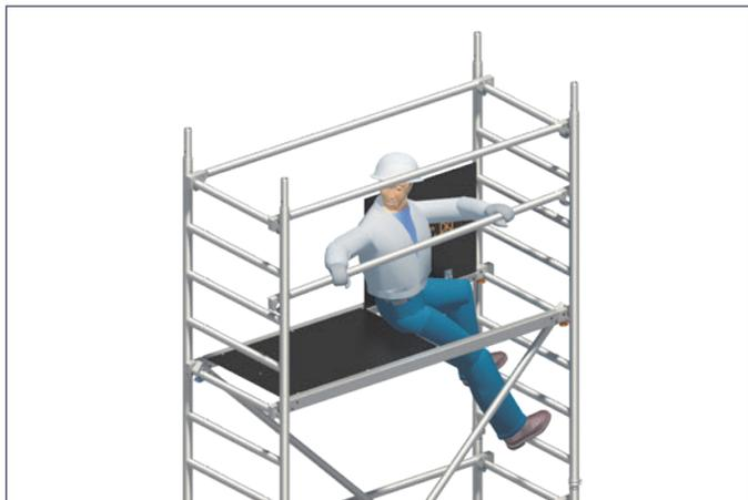
2. In der Durchstiegsöffnung sitzend, absturzgesichert durch die Holme der Durchstiegsbrücke **31**, erfolgt die Demontage der Zwischen Geländer der jeweiligen Lage. Hierzu werden die Geländer **20** an den zweiten Sprossen über der Standfläche demontiert. Sollten die Einrastklauen der Geländer **20** aus der sitzenden Position in der Durchstiegsöffnung nicht erreichbar sein, erfolgt die Demontage wie unter **8.** beschrieben.
