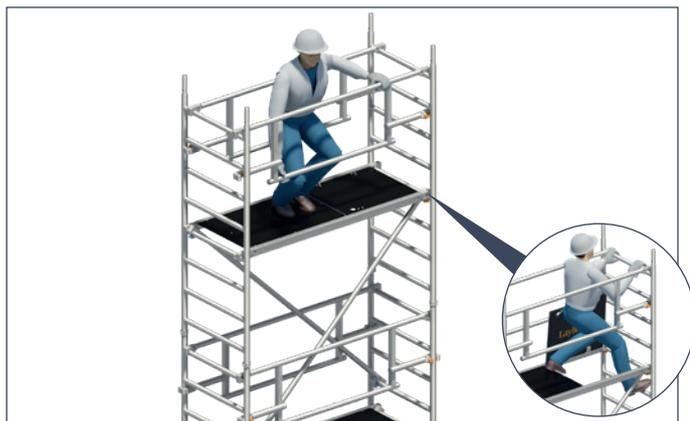
5. Aufsteigen und Betreten der nächsthöheren Plattform, die bereits vollständig mit zweiteiligem Seitenschutz gesicherten ist. Fixieren der Sicherheits-Doppelgeländer **22** durch leichten Druck nach außen um die unteren Klauen im Holmrohr der Standleiter einzurasten.
