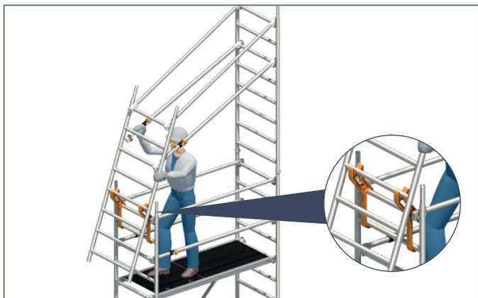
2. Anbringen der Uni Montagehaken **32** und Positionierung der zweiten Standleiter 75/8 **18**. Zwei Geländer **20** an der jeweils obersten Sprosse der aufgesteckten Standleiter 75/8 **18** einhängen und mit einer zweiten Standleiter 75/8 **18** verbinden. Zwei Uni Telegeländer **23** jeweils zwei Sprossen unter den Geländern **20** einhängen und diese in der entsprechenden Sprosse ebenfalls mit der zweiten Standleiter 75/8 **18** verbinden.
