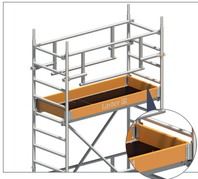
Zum Abschluss der Arbeitsbühne müssen Bordbretter mit Klaue **33** und Stirnbordbretter **34** angebracht werden.
