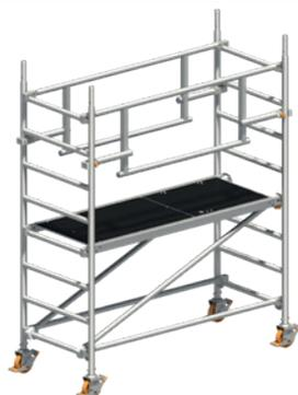
1. Die Lenkrollen **1** werden in die Standleitern 75/8 **18** eingesteckt und durch Festdrehen der Flügelschrauben an den Spindelmuttern gegen Herausfallen gesichert.
