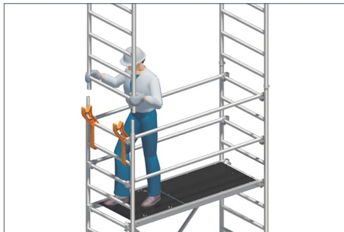
3. Durchstiegsbrücke **31** und Diagonalen **26** demontieren.
