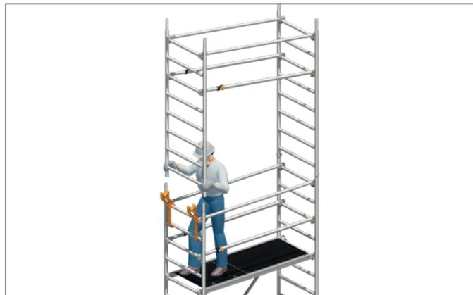
3. Die zweite Standleiter 75/8 **18** mitsamt dem vormontierten Seitenschutz nach oben schwenken, aufstecken und mit Federsteckern **19** sichern.
