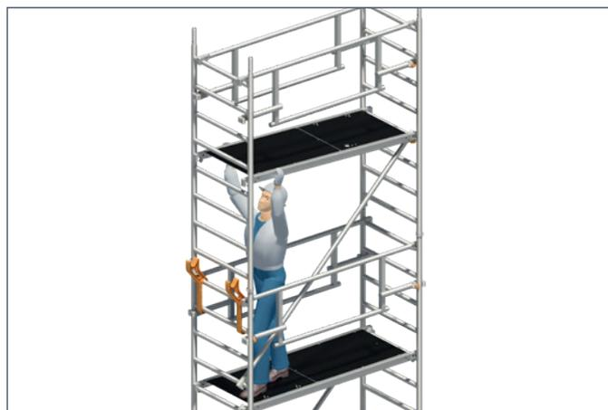
4. Die zweite Diagonalen **25** und die Durchstiegsbrücke **31** einsetzen.
