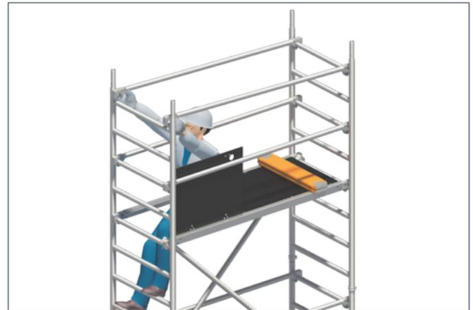
8. In der Durchstiegöffnung sitzend, absturzgesichert durch die Holme der Durchstiegsbrücke 31, erfolgt das einseitige Lösen und Auflegen der Einrastklauwe von beiden Geländerholmen auf der Seite der Durchstiegsklauwe in 1 m Höhe über der Standfläche.
