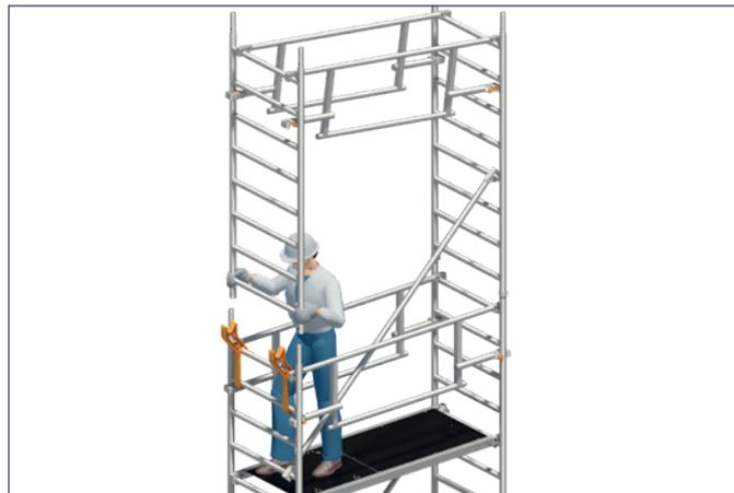
3. Die Standleiter 75/8 **18** aus der Position in den Uni Montagehaken **32** nach oben schwenken, aufstecken und mit Federsteckern **19** sichern.
